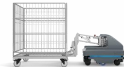
Transporter TR2 (odbiór obrobionych przedmiotów)
