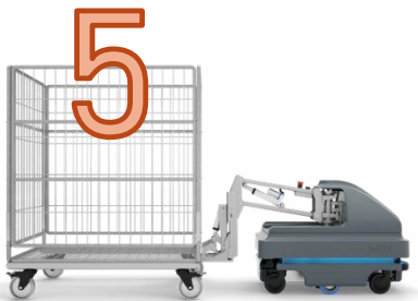
Transporter TR1 (przedmioty przed obróbką)
